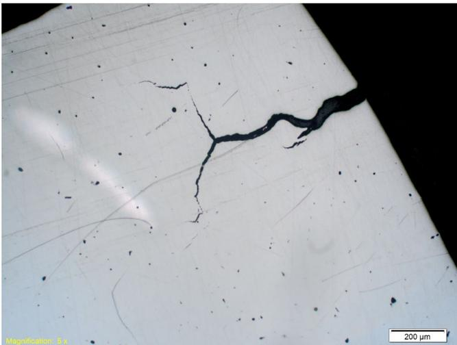
Figura 7. Micrografía obtenida de un acero de baja aleación con microestructura heterogénea usado en una pieza sometida a fatiga.
