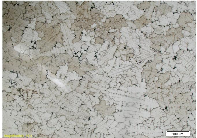
Figura 4. Micrografía obtenida de un acero usado en un componente de máquinas agrarias, evidenciando la precipitación de carburos en los límites de grano.
