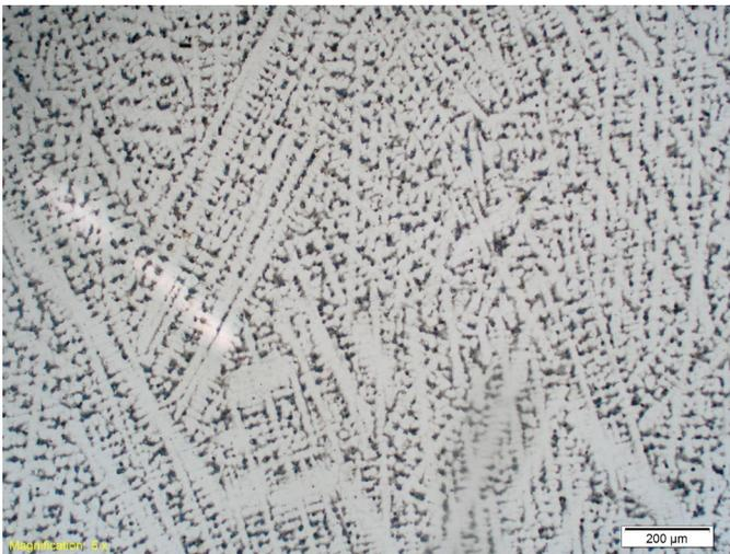
Figura 3. Micrografía obtenida de un acero usado en un componente de máquinas agrarias, evidenciando la presencia de una estructura dendrítica sin tratamiento térmico.
