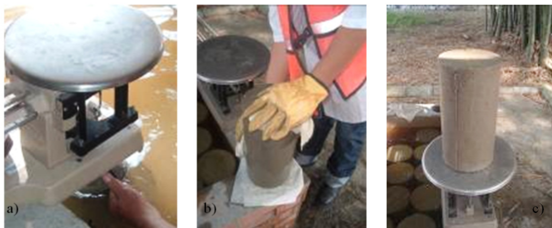
Figura 2. a) Espécimen de concreto sumergido en agua para peso sumergido, b) Proceso de secado manual para estado SSS del espécimen de concreto, c) Peso seco del espécimen de concreto
