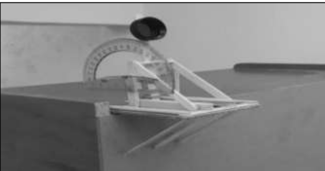
Figura 2. Segundo prototipo de la catapulta con una cuchara hecha de una tapa de botella y un palo de madera. Fuente: Los autores.
