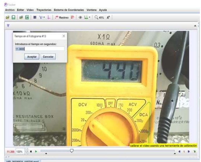
Figura 9. Captura de pantalla del Tracker para el voltímetro digital mostrando la lectura de 4,40 V para el instante de tiempo 11.365 s. Fuente: Los autores.
