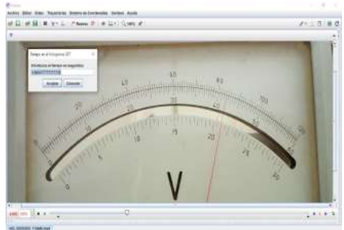
Figura 8. Captura de pantalla del Tracker para el voltímetro analógico mostrando la lectura de 4,2 V para el instante de tiempo 9.865 s. Fuente: Los autores.
