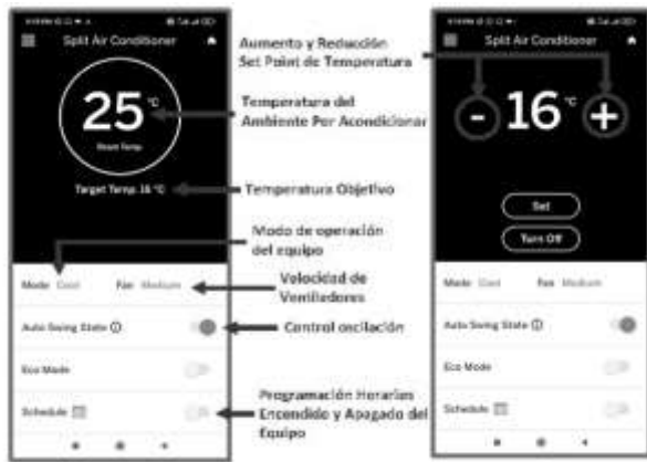
Figura 8. Interfaz aplicación MABE Refreshing Air . Pantalla principal (derecha), pantalla definición del set point de temperatura (izquierda). Fuente: Los autores.
