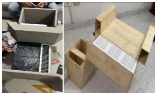
Figura 2. Izquierda, bocatoma hecha con cielo raso y perfil metálico; derecha, bocatoma hecha con madera y rejillas de ventilación Fuente: fotografías realizadas por estudiantes.
