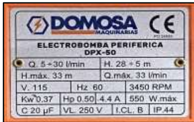
Figura 9. Características de la bomba según el fabricante Fuente: Fotografía tomada en el Laboratorio de Procesos de separación [19]
