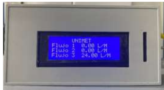
Figura 12. Lectura del sensor de flujo a la salida de la bomba. Fuente: Fotografía tomada en el Laboratorio de procesos de separación
