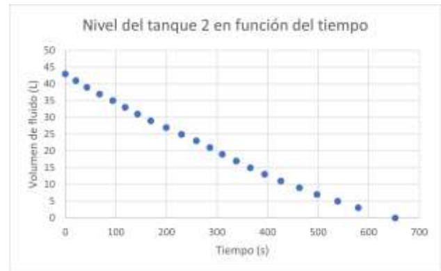
Figura 19. Gráfica de vaciado del tanque 2 real. Fuente: gráfico generado por el simulador desarrollado en Matlab® y Microsoft Excel [18] y [16].
