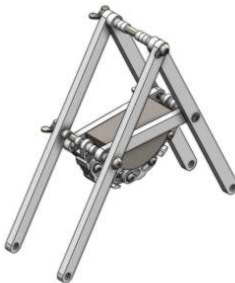
Figura 5. Alternativa de disposición del banco de pruebas para sensores MFL y UT – EMAT, con disposición vertical de la probeta. Fuente: Autores
