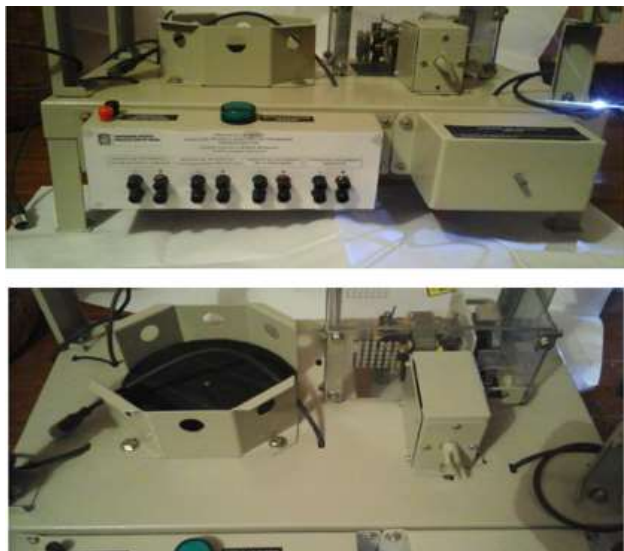
Figura 4. Montaje general de banco didáctico de pruebas de sensores inductivos, fotoeléctricos y de ultrasonido. Fuente: [7].
