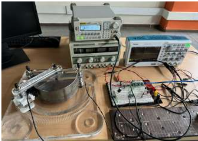
Figura 8. Pruebas para sensores MFL y UT – EMAT, en banco de pruebas con disposición horizontal de la probeta. Fuente: Autores
