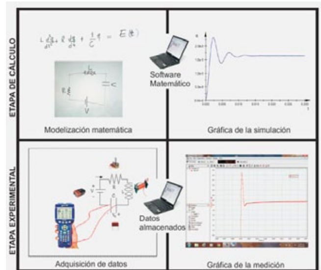
Figura 6. Ilustra la vinculación de la fase experimental con la fase de cálculo y la integración mediante la tecnología informática
