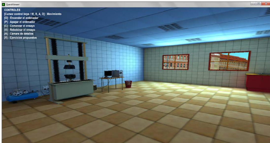
Figura 1. Realismo de la máquina virtual de ensayos de tracción dentro de un laboratorio.
