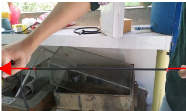
Figura 4. Aplicación de fuerza de tracción en caucho tipo Pib Butilo Fuente: el autor.
