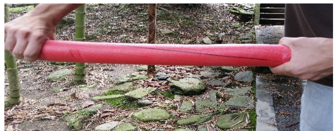
Figura 3. Aplicación de par torsor sobre probeta circular en poliuretano Fuente: el autor.
