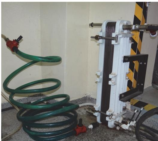
Figura 2. Equipos disponibles para el enfriamiento del mosto. A la izquierda, el intercambiador tubular y a la derecha, el intercambiador de placas.
