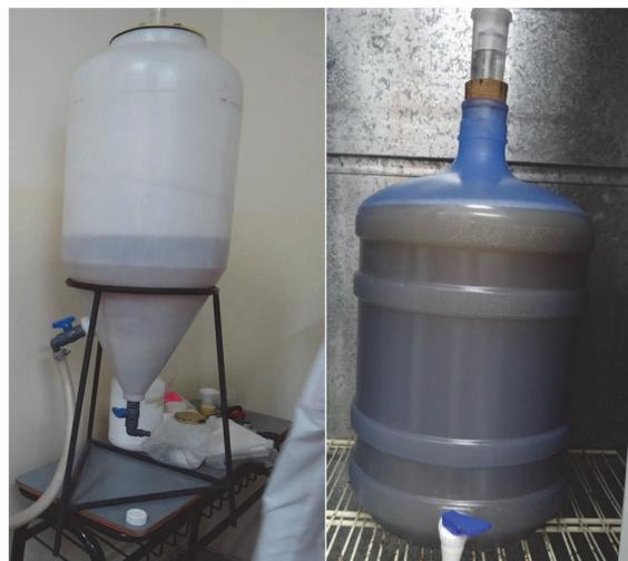
Figura 3. Fermentadores disponibles en la planta piloto. A la izquierda, el fermentador de 60 L y a la derecha el fermentador de 20 L.
