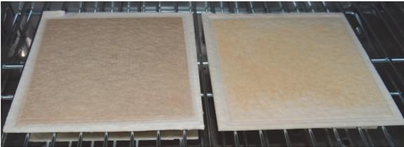
Figura 5. Placas de celulosa con la capa de tierra de diatomea. La placa de la izquierda corresponde al proceso de filtración y la segunda al de estabilización.
