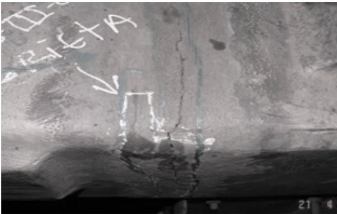
Figura 1. Grieta de 1000 mm en U, camión C327 - puente delantero.
